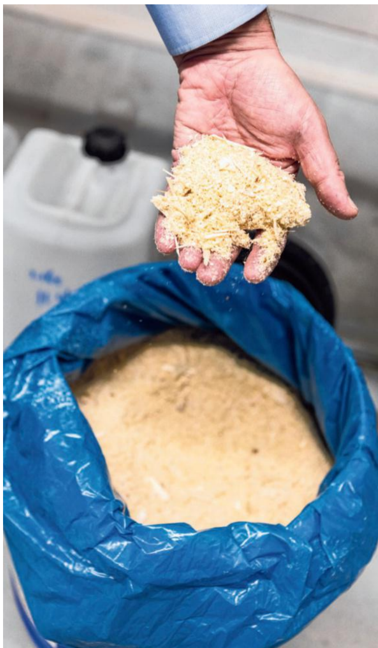
In een grote hal van de Brightlands Chemelot Campus in Limburg worden proeven gedaan om uit zaagsel lignineolie te maken. Dit product kan als grondstof dienen voor bijvoorbeeld plastic, chemicaliën en brandstof.
